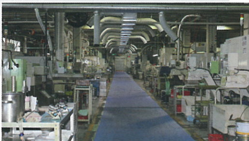
ワンウェイで中央通路の両脇に配置された複合 NC 旋盤
